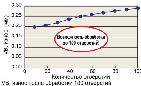
VB, износ после обработки 100 отверстий
